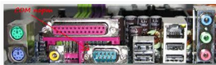
Рис. 3. Порты для контактного подключения к персональному компьютеру (конец 1990-х гг.).
